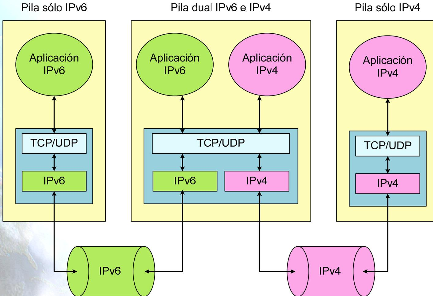
Mécanismo basado en doble pila
